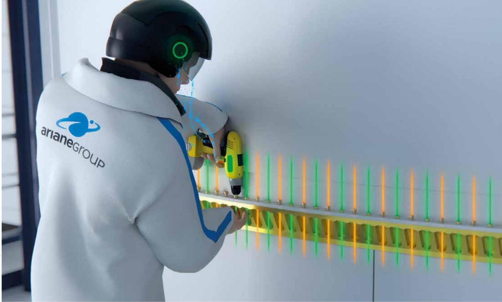
Bei der Oberstufenmontage der Ariane 6-Trägerraketen in Bremen kommen Drehmomentschlüssel mit Datenübertragung und Augmented-Reality-Tools zum Einsatz.
