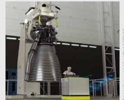
Fahrerlose Transportfahrzeuge und RFID-Chips garantieren bei der Vulcain 2.1-Triebwerksmontage im französischen Vernon, dass die korrekten Werkzeuge und Bauteile an die richtige Arbeitsposition kommen.
