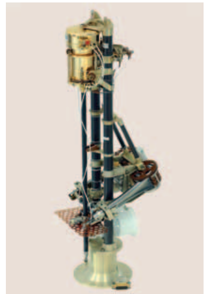
Das Experiment MUPUS zur Messung der Oberflächentemperatur und der physikalischen Eigenschaften des Kometenmaterials. The MUPUS experiment for measuring the surface temperature and physical properties of the cometary nucleus.
