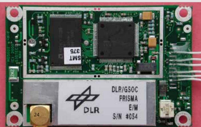
Hoch-präzise Navigation der TanDEM-X Formation mittels GPS
