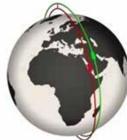
Schema der relativen TSX und TDX Orbits
