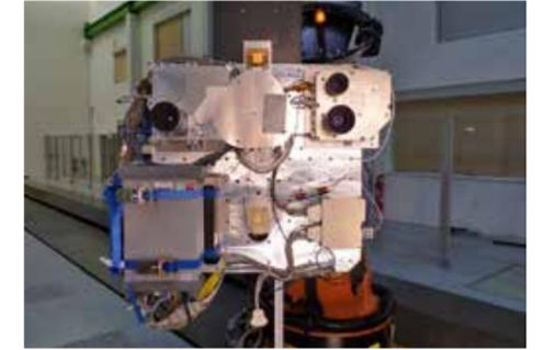
Kamerasystem zur Anflugnavigation montiert auf einem Roboter
