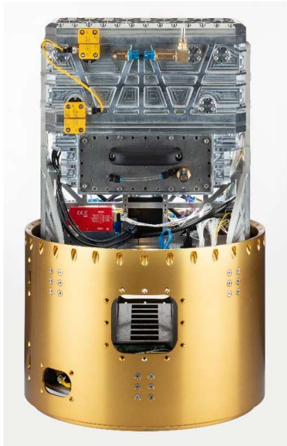
Abbildung 1: Links: MARS Nutzlast mit geöffneter Außenstruktur. Rechts: Blick in die Druckkammer.
