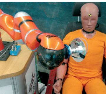
Bild: Standardisierte Crashtests für die Evaluierung von „Sicherheit in der Mensch-Roboter-Interaktion“.
