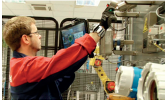
Ausgabe von Bewegungsanweisung für den Arm (Richtung, Distanz, Entfernung) zum Beispiel für augmentierte Realität
