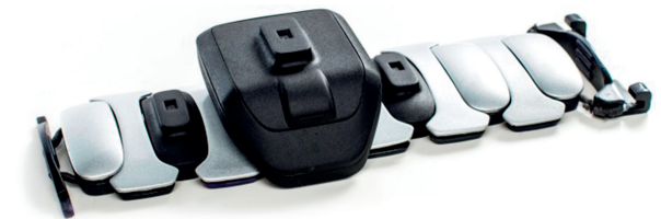
Prototyp des taktilen Armbands mit drei integrierten Distanzsensoren
