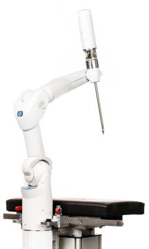
Für präzise Manipulationsaufgaben ist alternativ ein positionsgeregelter Betrieb des Roboters möglich. Die Spezialisierung des vielseitigen Leichtbauroboters MIRO erfolgt über seine Instrumentierung sowie anwendungsspezifische Software.
