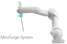
Das MiroSurge-System ist eine Forschungsplattform zur Entwicklung neuer Technologien im Bereich der minimalinvasiven robotergestützten Chirurgie.
