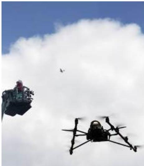
**Abbildung 12: Der Oktokopter (Vordergrund), die Cessna 208B Grand Caravan (Hintergrund) sowie die Empfangsantenne im Feuerwehr-Hubsteiger parallel im Einsatz.**
