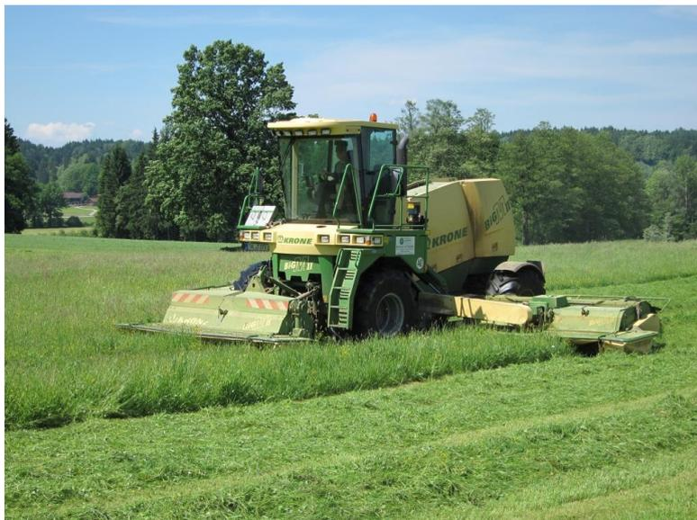
**Bild 1:** Selbstfahrender Hochleistungs-Mähaufbereiter "Krone Big M"
