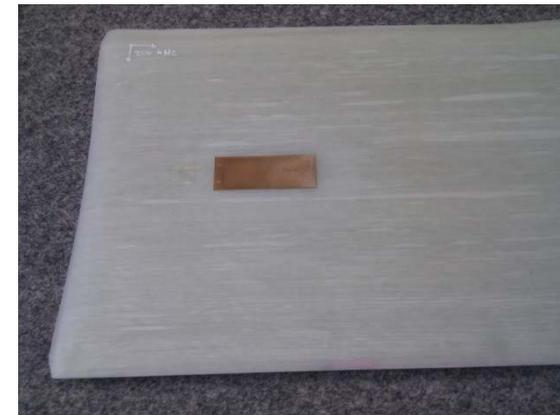
Foto GFK Probekörper mit PZT Sensor
