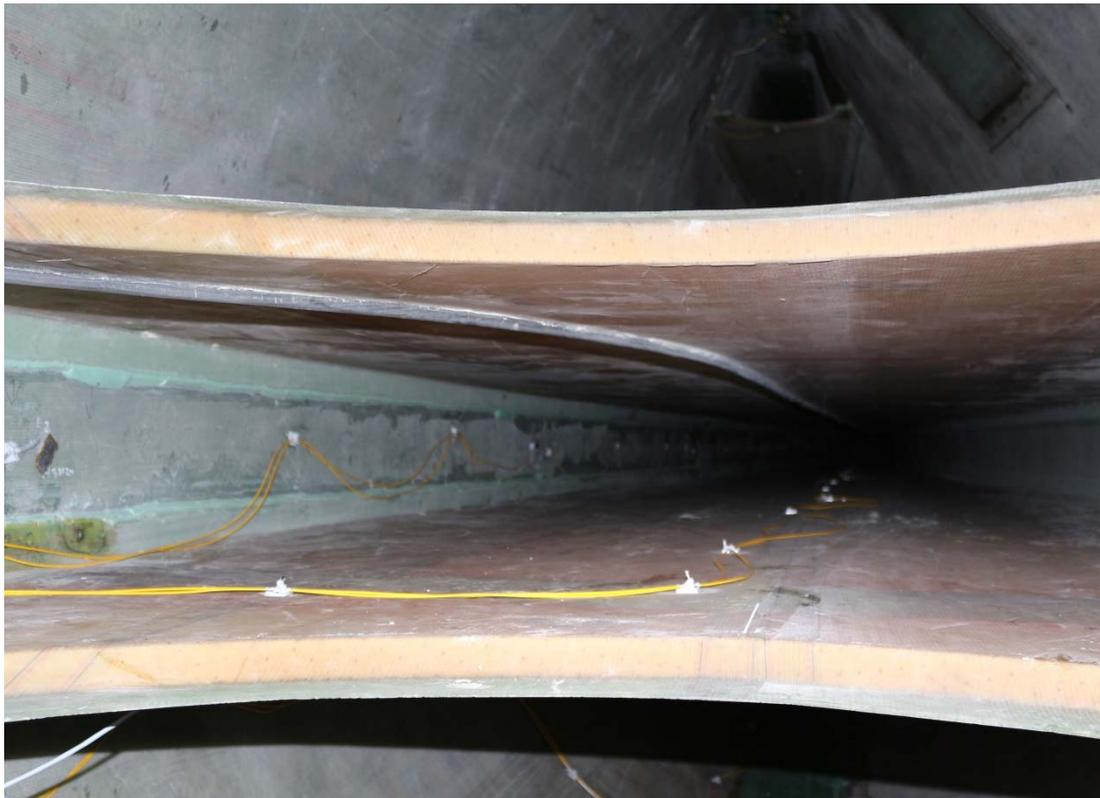
FBG-basiertes Load Monitoring System
