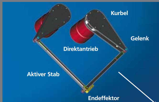
Fünfgelenk aus Kohlefaserbauteilen – Roboter mit aktiver Schwingungsunterdrückung
