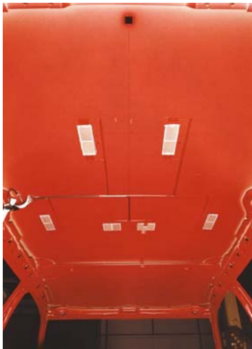
Bild 18: PKW-Dachblech mit applizierten Funktionsmodulen
