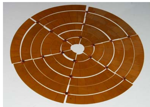
Bild 16: oben: Spezielles Funktionsmodul für den adaptiven Reflektor; unten: 36 Segmente für eine Deckschicht des adaptiven Reflektors
