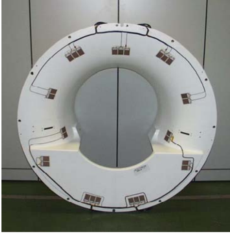
Bild 17: Verkleidungskomponente eines MRT mit applizierten Funktionsmodulen
