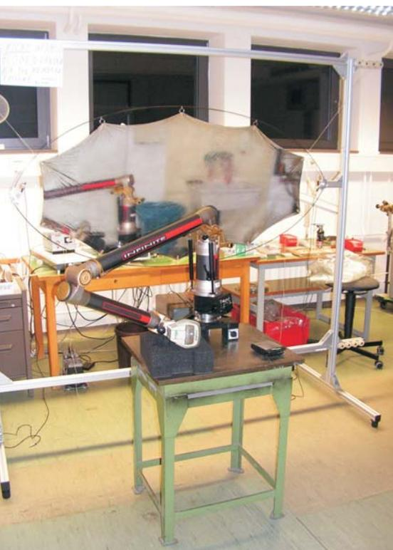
**Funktionstest an einem Sub-scale Modell im Labor. Vermessung der Membranoberfläche mit einem berührungslosen, laserbasierten Messverfahren.**
