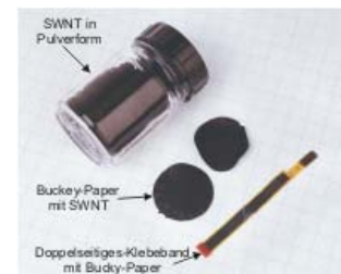
Bild 10: SWNT Bucky-Paper mit 50% Nanotubeanteil
