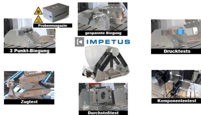
Verfügbare Testaufbauten für die dynamische Materialcharakterisierung
