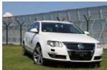
FASCar II: Erprobung hochentwickelter kooperativer Assistenz und Automation in realem Drive-by-Wire- basiertem Versuchsträger. Hierbei mit Schwerpunkt auf der Transitionsgestaltung zwischen verschiedenen Automationsgraden.
