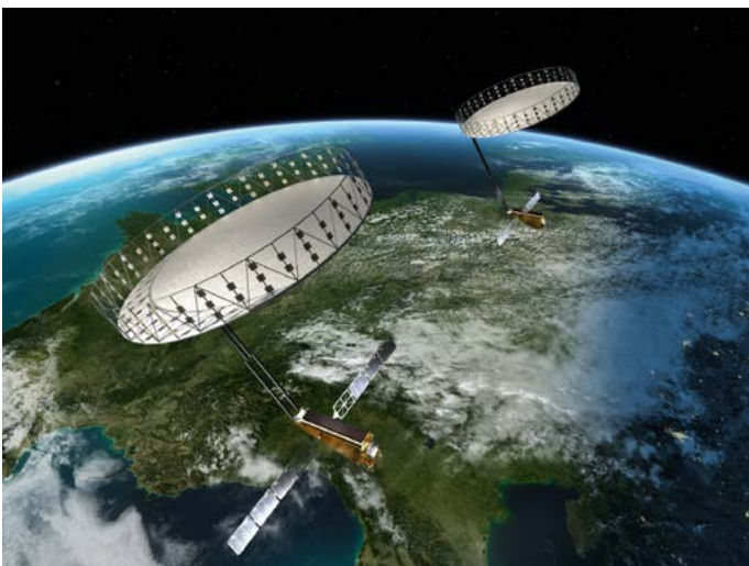
Die Tandem-L-Satelliten mit entfaltbaren Reflektorantennen im Formationsflug
