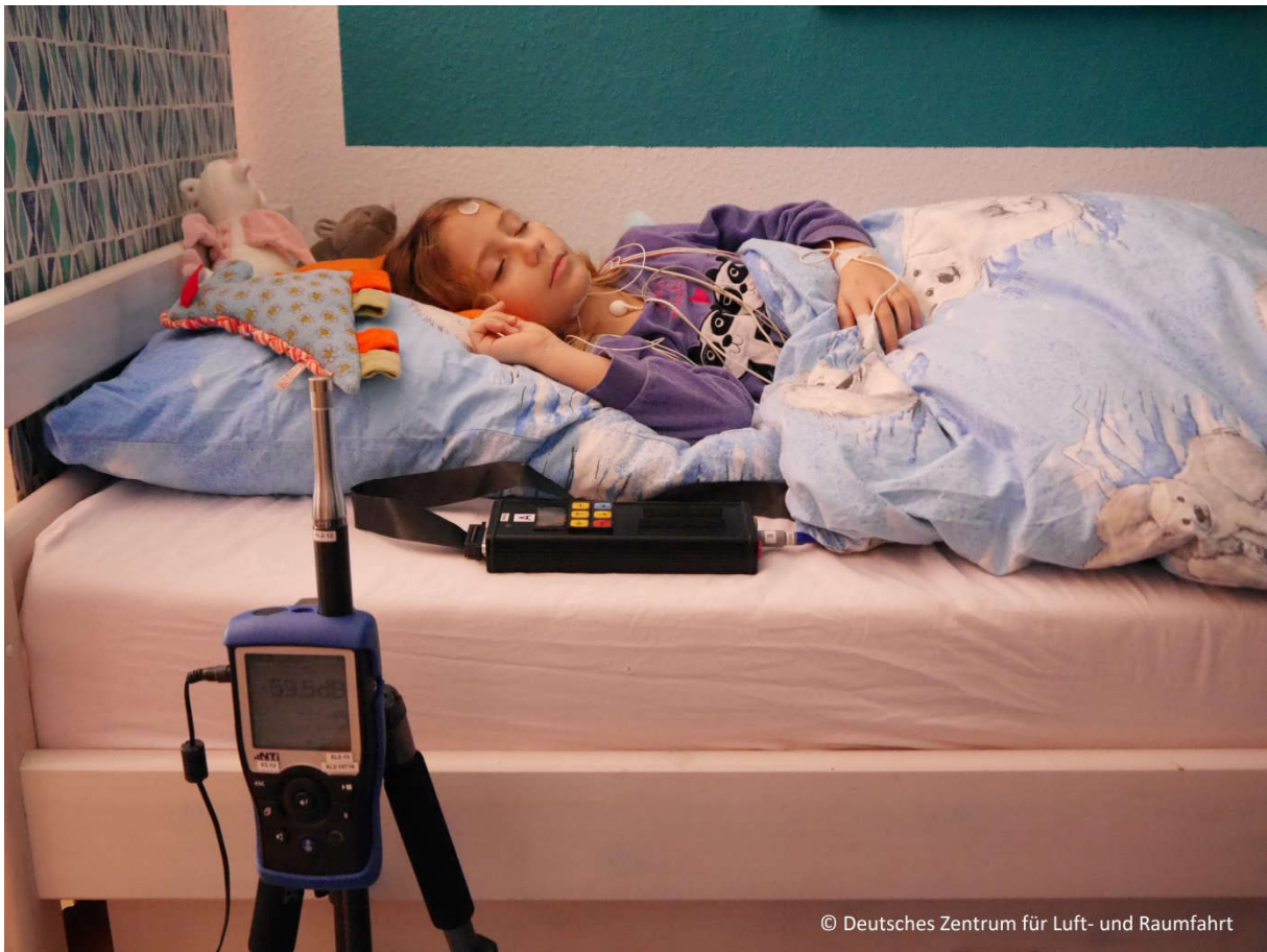
Abbildung: Versuchsaufbau im Kinderzimmer mit elektrophysiologischen Instrumenten zur Schlafmessung und mit Geräten zur Geräuschaufzeichnung.
