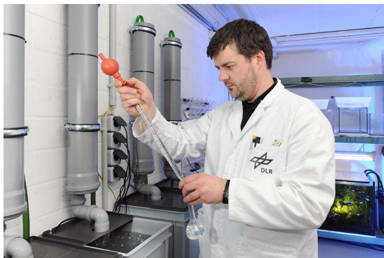
Abb. 1: Erste Messanlagen zur Quantifizierung und Charakterisierung von Biofiltern beim Abbau von Harnstoff im Institut für Luft- und Raumfahrtmedizin.
