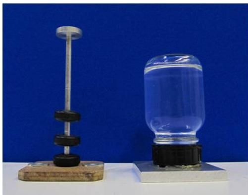
Abb. 4: Magnetisches Gravimeter (links) und Wasser-Luft-System (rechts)
