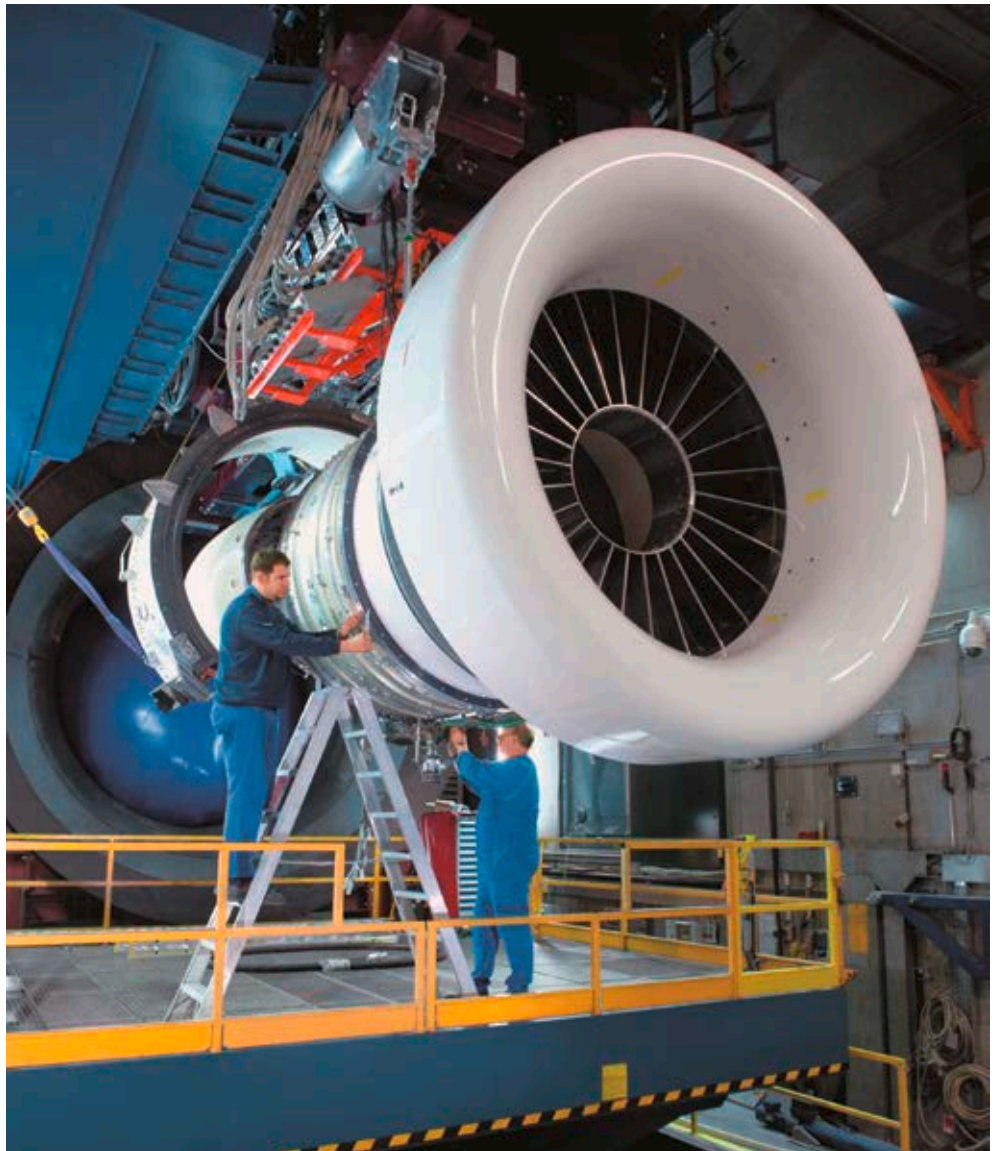
Der Antrieb der Zukunft, der Getriebefan PW1100G-JM, wurde auf dem MTU-Prüfstand in München getestet.
