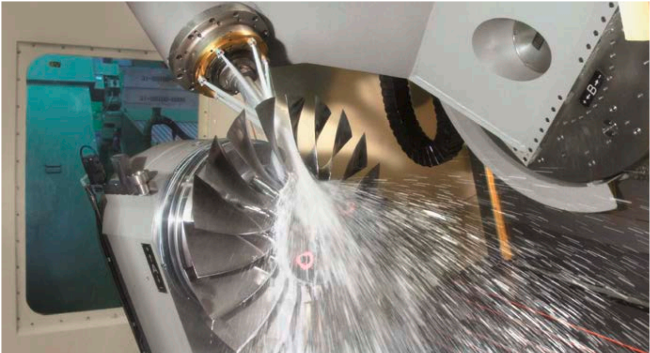
Die MTU ist weltweit einer der führenden Hersteller von Blisks. Blade Integrated Disks sind Hochtechnologie-Bauteile, bei denen Scheibe und Rotorschaukeln integral gefertigt werden.
