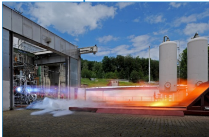
Versuche mit der Treibstoffkombination Flüssigwasserstoff und Methan am Prüfstand P3.
