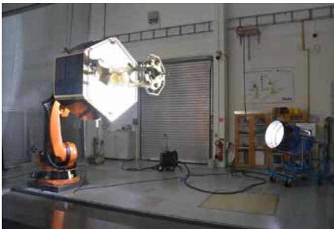
Hochleistungs-Sonnensimulation zur Targetbeleuchtung
