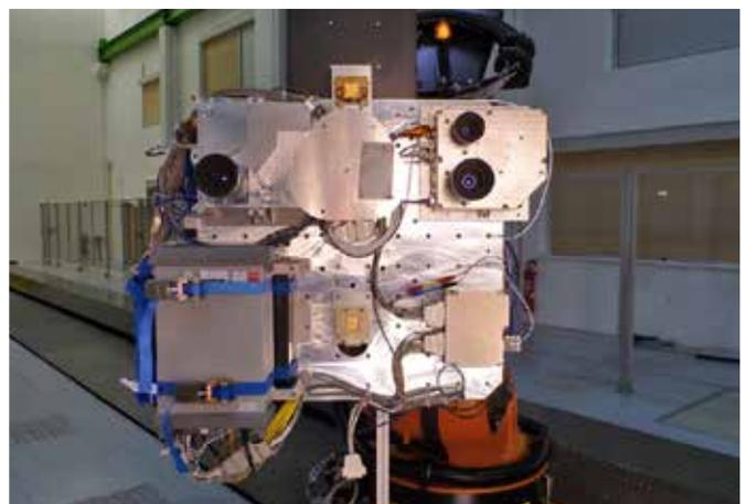
Kamerasystem zur Anflugnavigation montiert auf einem Roboter
