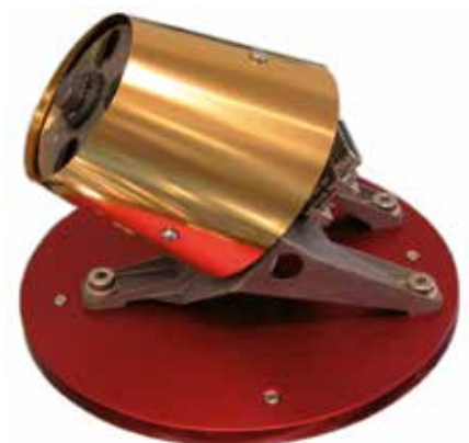
Bestandteil des HP 3 -Experiments ist das Radiometer RAD. Es misst vom Instrumentendeck die Strahlung der Oberfläche, die in etwa der Oberflächentemperatur entspricht.
