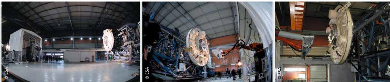
Auf der 120 Tonnen schweren mobilen Plattform (rechts) wurde die ATV-Andockstelle der ISS nachgebaut. Gegenüber, auf der linken Seite, wurden die Flugsensoren auf den Arm eines Industrie-Roboters montiert. Die Relativgeschwindigkeit zwischen den beiden Geräten war genau so hoch, wie sie beim Andockmanöver zwischen Jules Verne und der ISS erwartet wurde.
