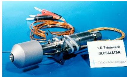
1 N Hydrazin Triebwerk
