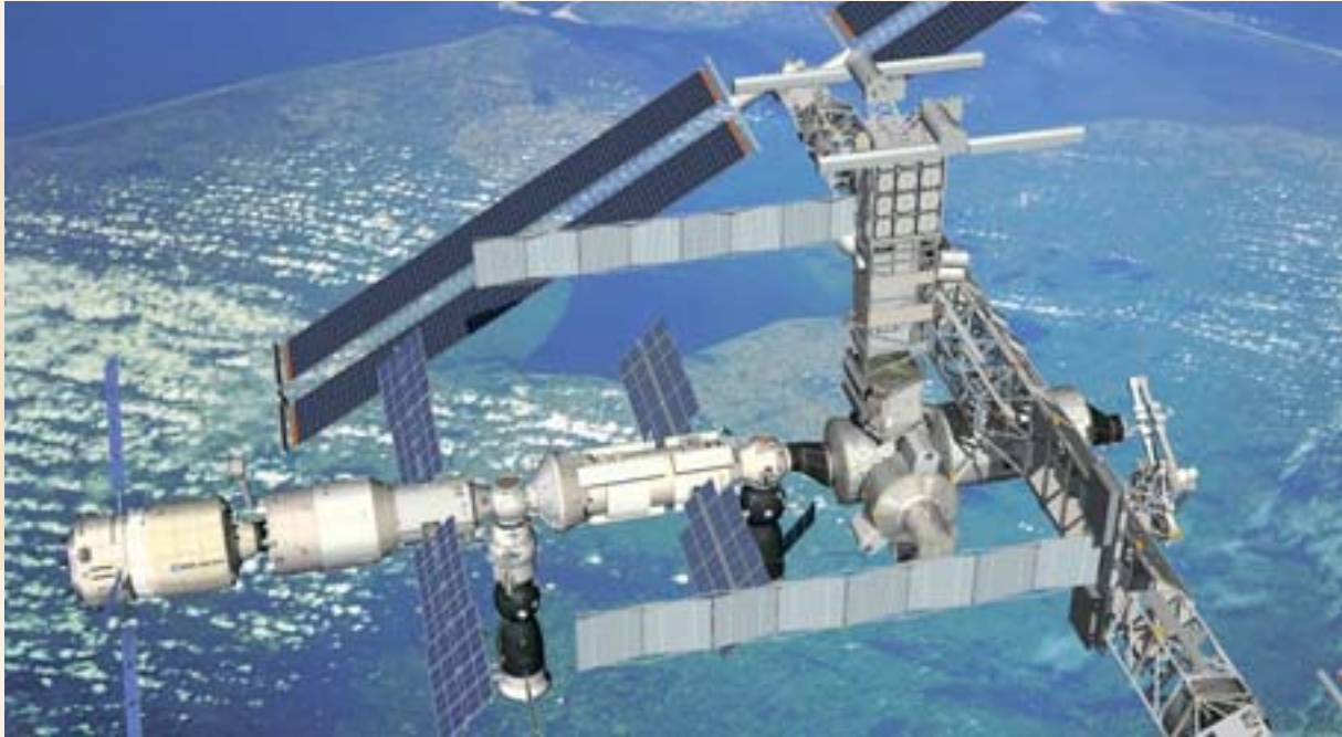
ISS mit ATV. Eine wesentliche Aufgabe des modular aufgebauten ATV ist, in regelmäßigen Abständen die Raumstation in ihre ursprüngliche Bahn anzuheben.
