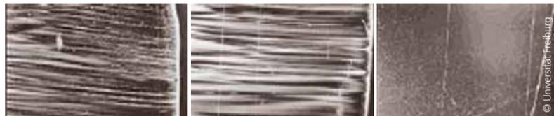
Querschnitt durch einen mit freier Schmelzoberfläche gezüchteten Halbleiterkristall auf der Erde (links) und unter Schwerelosigkeit (Mitte). Keine Verbesserung der streifenförmigen Dotierstoffverteilung. Solche Inhomogenitäten werden erst durch eine bedeckte Schmelzoberfläche (rechts) oder andere Maßnahmen unterbunden.
