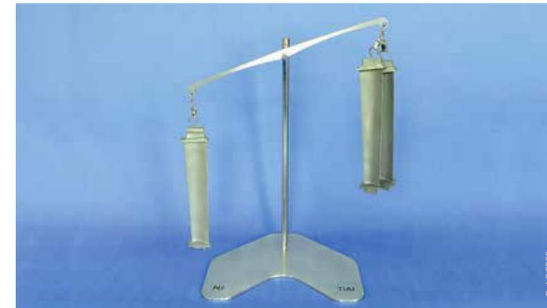
Auf TEXUS-Flügen wird auch Forschung betrieben, die den Turbinenbau revolutionieren und Turbinenschaufeln leichter machen soll. Dazu werden besondere Legierungen in Schwerelosigkeit aufgeschmolzen, unter kontrollierten Bedingungen erstarrt und deren Eigenschaften untersucht. Eine Schaufel auf Titan-Aluminium-Basis ist zum Beispiel nur halb so schwer wie eine gewöhnliche nickelbasierte Schaufel.
