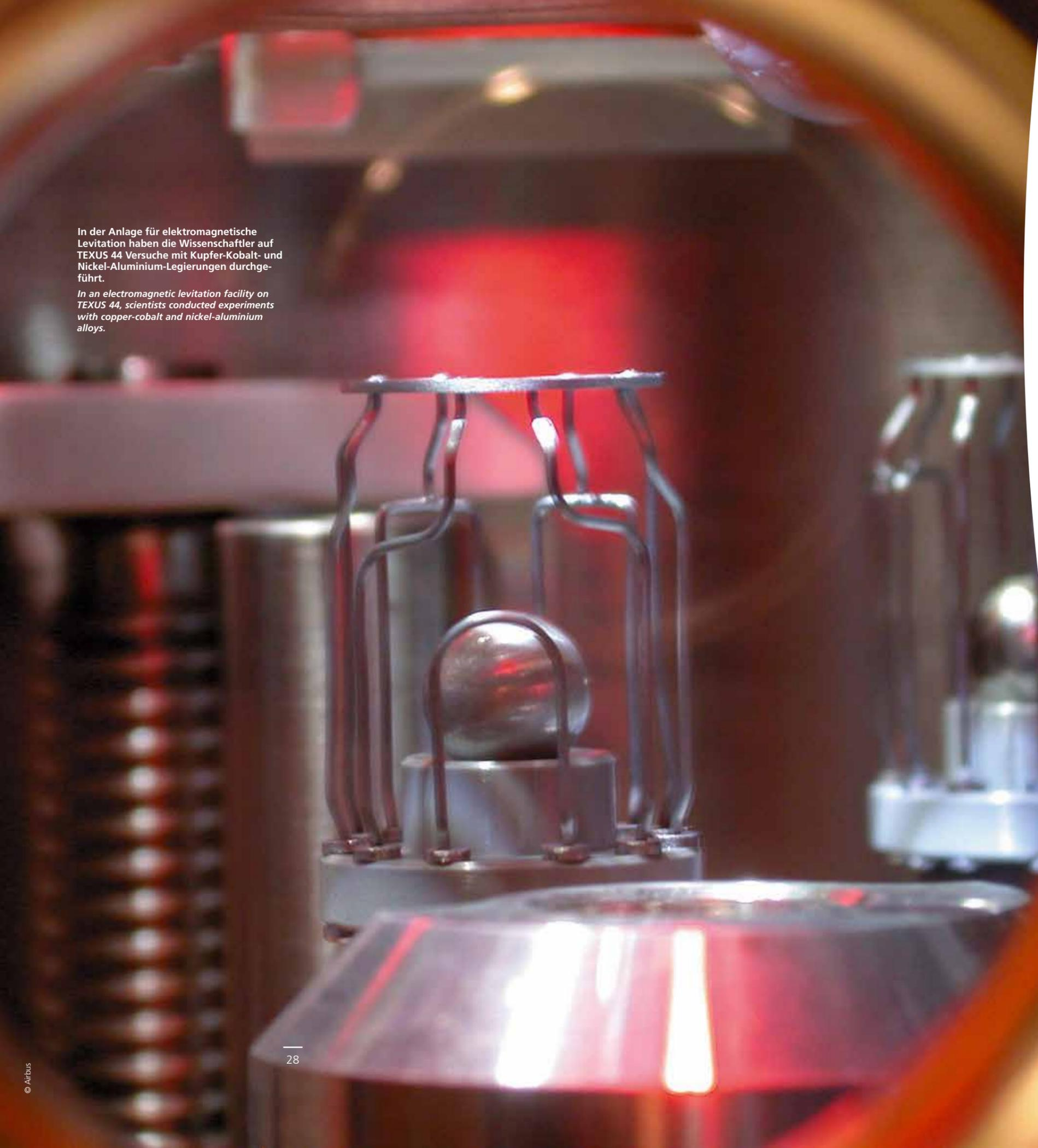
In der Anlage für elektromagnetische Levitation haben die Wissenschaftler auf TEXUS 44 Versuche mit Kupfer-Kobalt- und Nickel-Aluminium-Legierungen durchgeführt.
