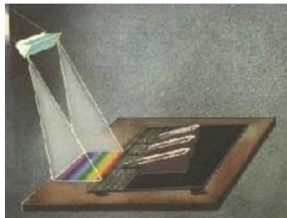
Abb. 5: Herschels Idee: Das Licht wird durch ein Prisma aufgespalten und in ein Farbspektrum zerlegt.
