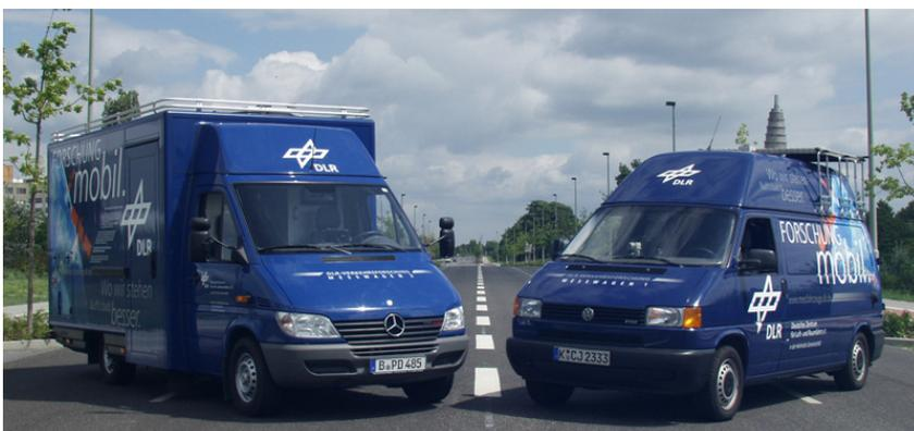
Abb. 4: Zur dezimetergenauen Positionsbestimmung sind die Messfahrzeuge des DLR mit DGPS ausgestattet
