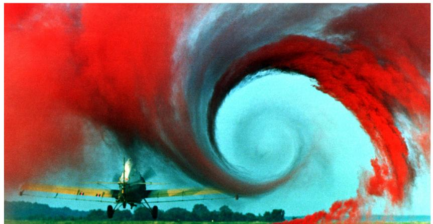
Abb. 2: Wirbelschleppe eines startenden Flugzeuges
