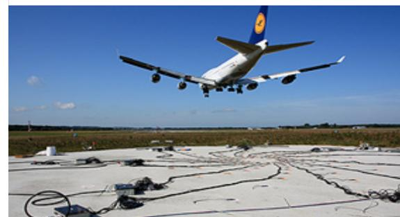
Mit Mikrofönen werden die Lärmquellen eines Flugzeugs lokalisiert.
