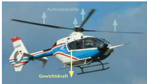
DLR-Forschungshubschrauber Eurocopter EC 135 FHS Vier Rotorblätter erzeugen den zum Ausgleich der Gewichtskraft notwendigen Auftrieb.
