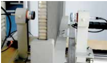
Prüfstand mit Ultraschallsender (rechts) und Empfänger (links) ohne Werkstück.
