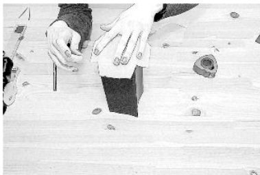
16. Schneide die Ecken bis zum eingezeichneten Rechteck ab und klebe die Seiten der Transparentfolie mit Klebeband auf die Öffnung.
