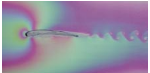
Umströmung eines Tragflügels im Seifenfilmkanal.
