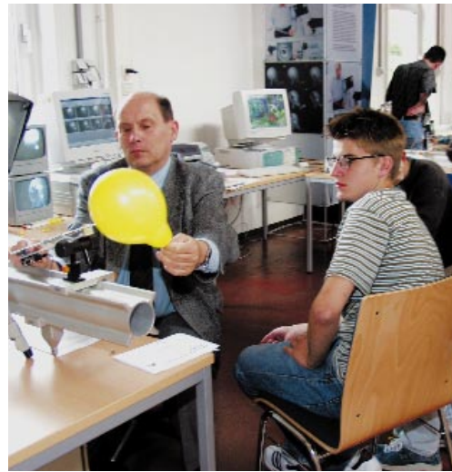
Links: Akustischer Hohlspiegel zur Lärmquellenortung am Auto.
