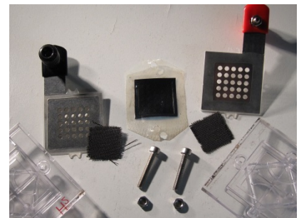
Abb. 4: Bauteile einer einfachen Brennstoffzelle
