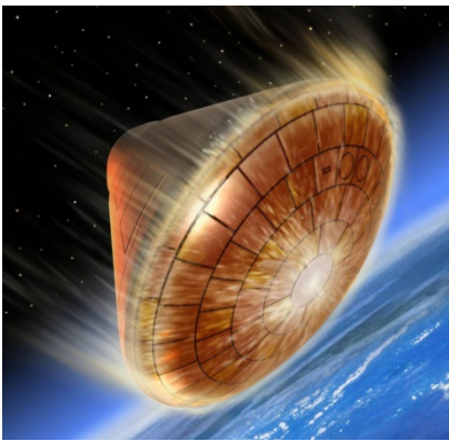
Beim Wiedereintritt in die Erdatmosphäre mit 12.000 km/h müssen Hitzeschilde nicht selten Temperaturen von 5.000°C standhalten. Das ist so heiß wie die Oberfläche der Sonne!
