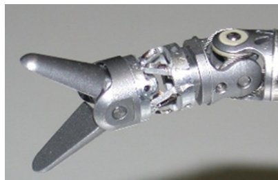
Abb. 2: Winziger Greifarm für chirurgische Eingriffe
