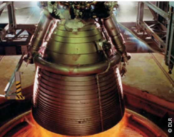
Das Hauptstufentriebwerk der Ariane 5, hier im Prüfstand im DLR-Standort Lampoldshausen, erzeugt einen Schub von mehr als 1.000 kN. Unglaublich, wenn man sich an die Anfänge des Raketenbaus erinnert.
