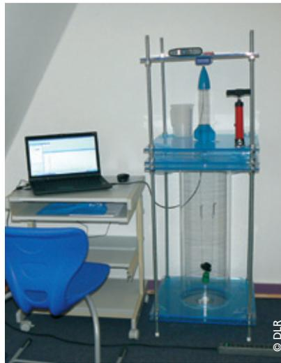
Modellprüfstand für Wasserraketen im DLR\_School\_Lab
