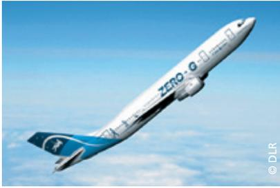
Der Airbus A300 Zero-G während des Aufstiegs in der Parabelbahn
