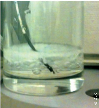
Bei Raumtemperatur im Vakuum erstarrtes Wasser
