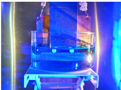
Abb. 6: Beschichtungsanlage. Der Wolframdraht wird über zwei Rollen durch das Elektrolyt-Bad geführt. Im Hintergrund ist die Kupferplatte zu erkennen, die als Anode dient.
