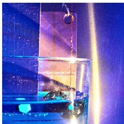
Abb. 7: Der verkupferte Wolframdraht (Ausschnitt aus Abb. 6)
