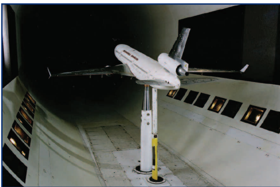
Flugzeugmodell im Windkanal der NASA
