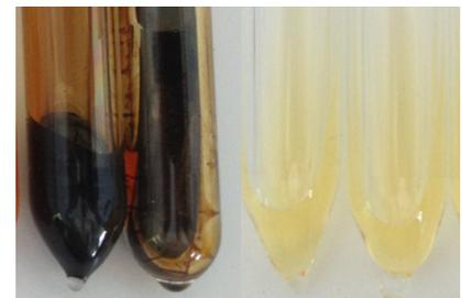
Abb. 3: BP/DPO Eutektikum (links) und HELISOL (rechts) in Glasampullen nach 10 Tagen bei 465°C
