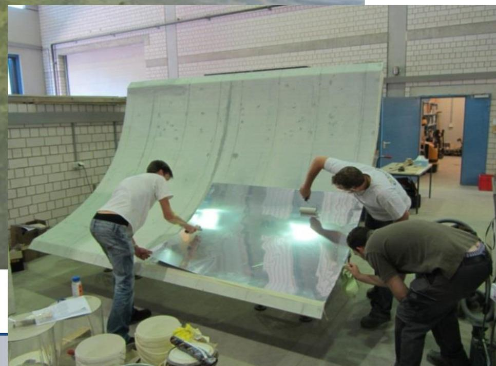
Mark: Betonschalen für Parabolrinnenkollektoren,
