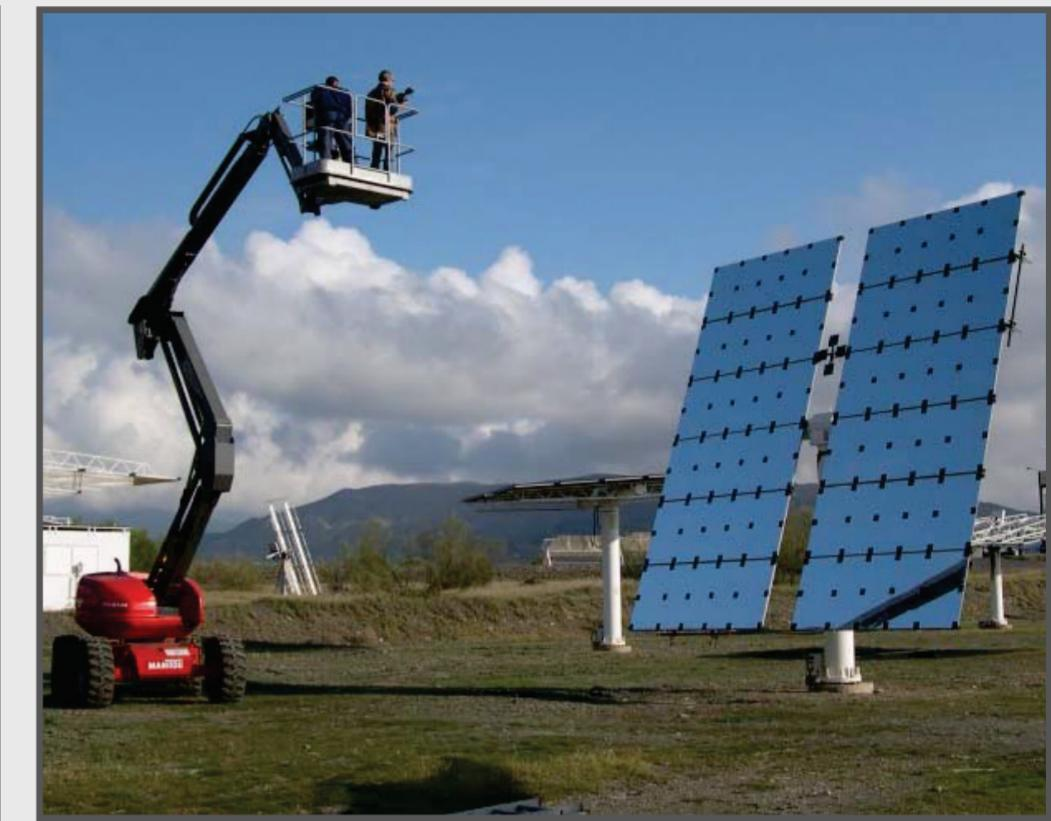
Fotografische Erfassung der auf den Spiegelfacetten aufgeklebten Reflektoren, zur Detektion der Spiegelformabweichung in Abhängigkeit der Gravitationskraft.
