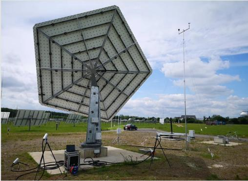
Heliostat-Testplattform in Jülich und Aufbau des Mehrkamera-Photogrammetriesystems sowie Aufstellung zweier Windmessmasten mit insgesamt vier Ultraschallanemometern
