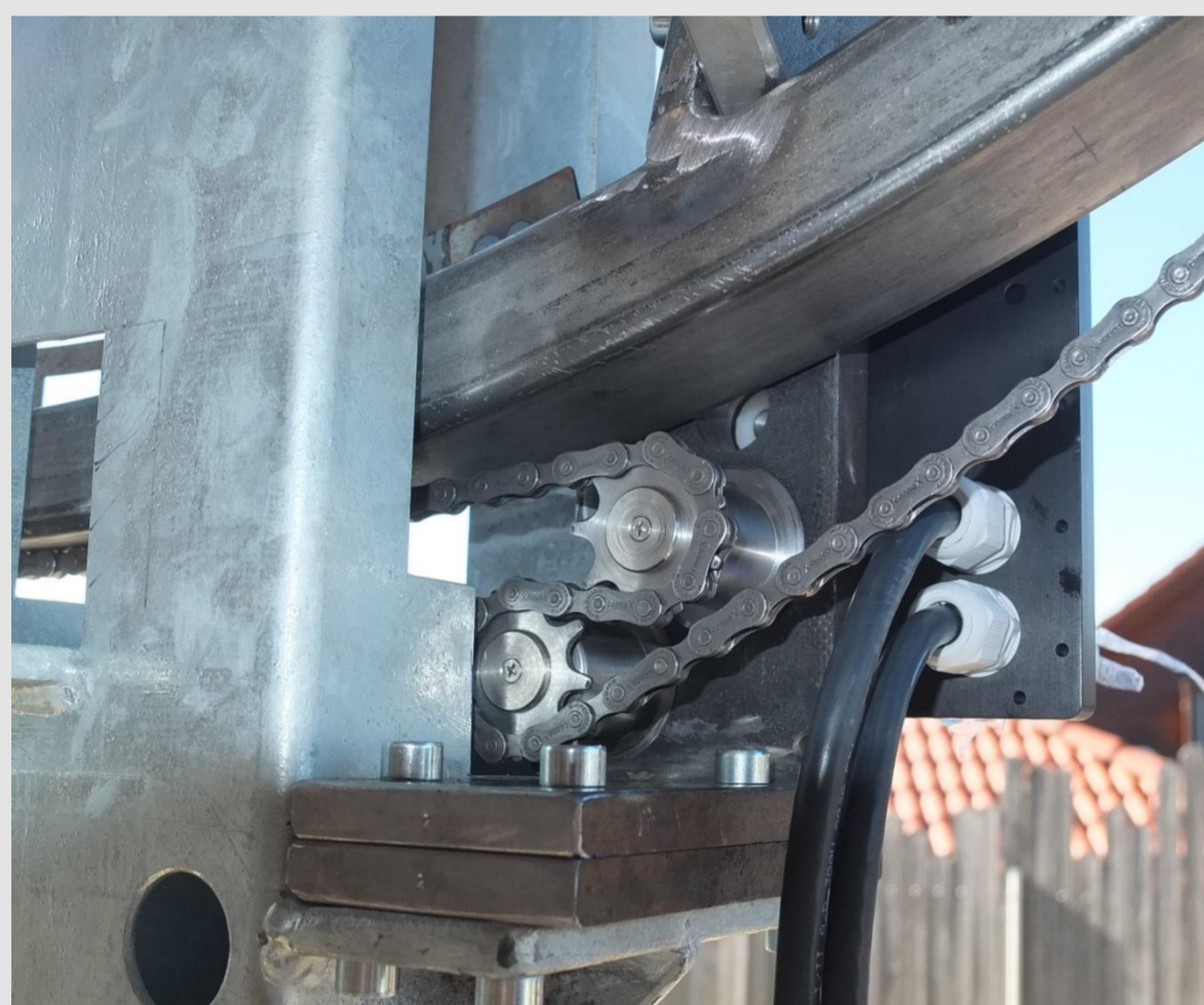
Abb. 1: Autonomer Radkranzheliostat mit Kettengetriebe
