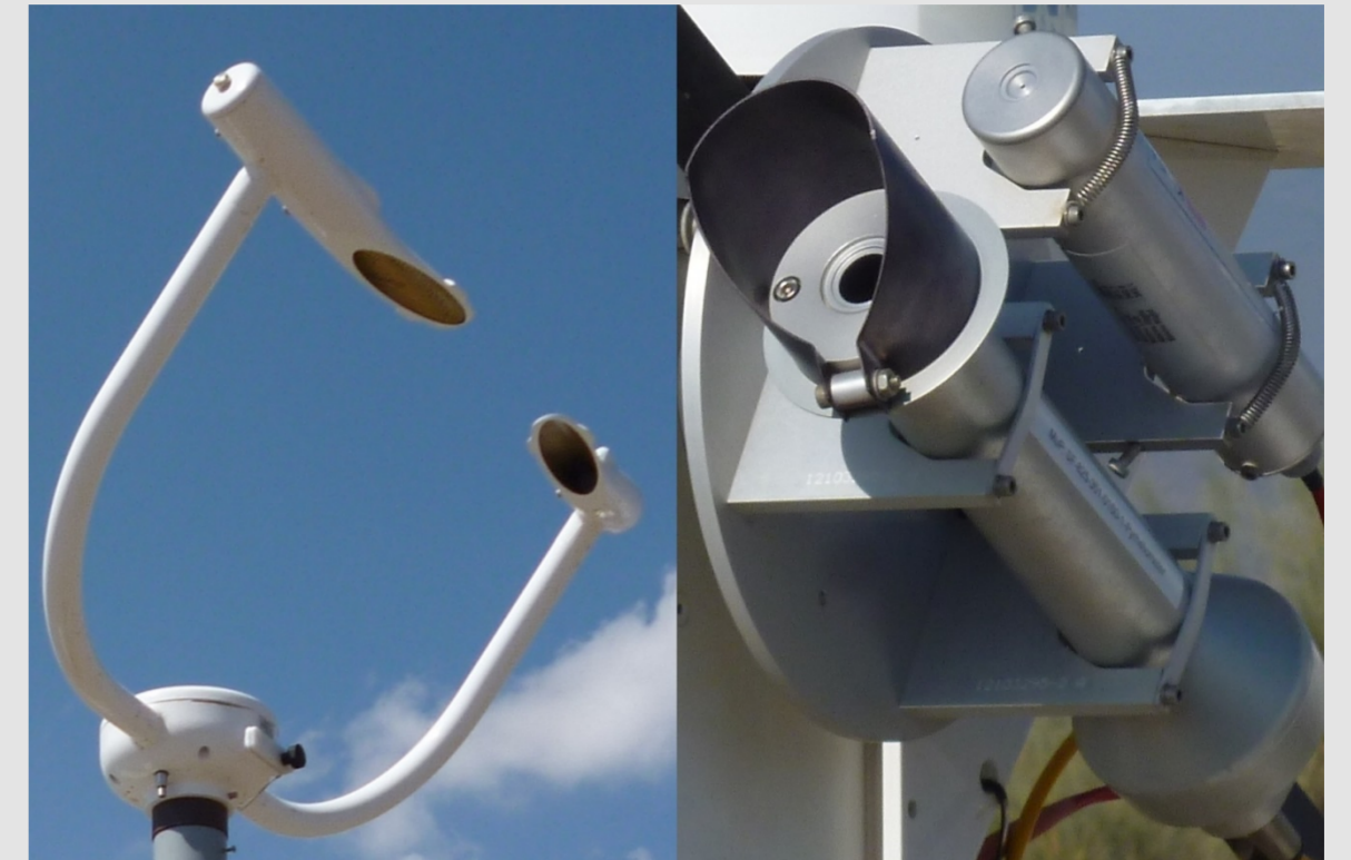
Abb. 2: FS11 Vaisala Streusensor (links), CHP1 Kipp & Zonen Pyrheliometer für DNI Messungen (rechts).
